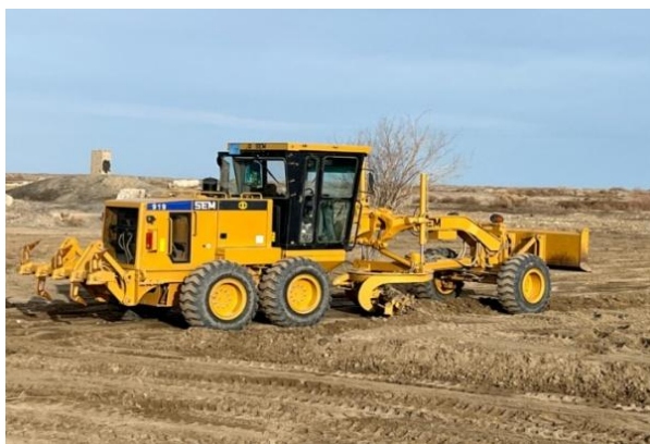
2-сурет – SEM-919 әмбебап автогрейдері
