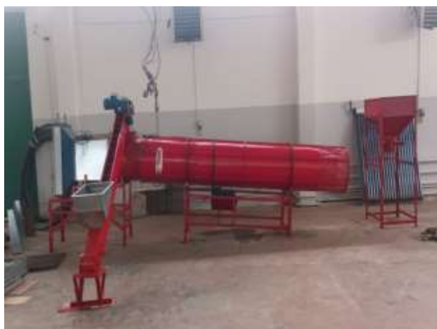
Рисунок 4 – Экспериментальный образец барабанной сушилки с гелиоколлектором
