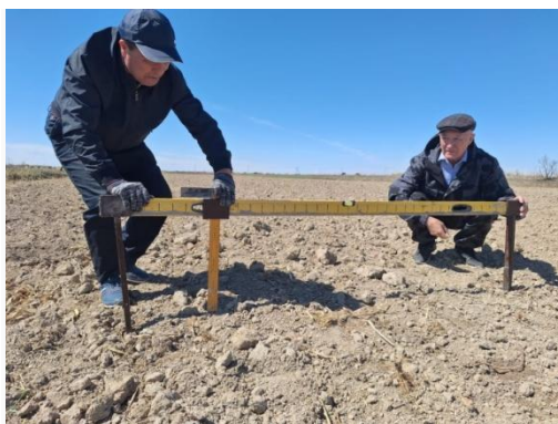
Рисунок 1 – Определение гребнистости поля с помощью профилографа
