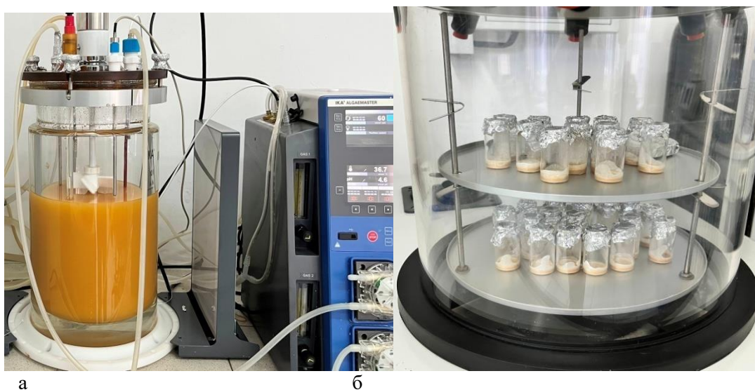
Рисунок 3 – Нарращивание биомассы дрожжей Metschnikowiapulcherrima МР-3: а – ферментация в биореакторе; б – вид культуры в лиофильной сушке
