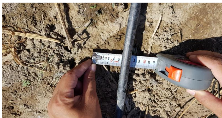
5-Сурет – Бір тамшылатқыштың ылғалдану аймағын өлшеу
