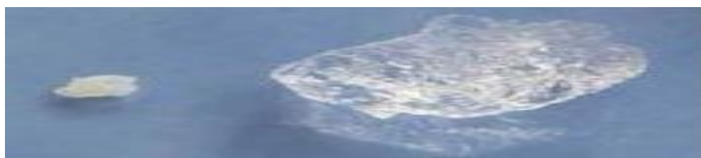
Рисунок 1- Гранула абсорбент до (а) и после (б) замачивания водой
