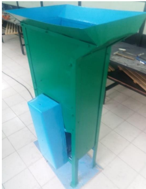
Рисунок 1 – Устройство для измельчения корнеплодов (общий вид)
