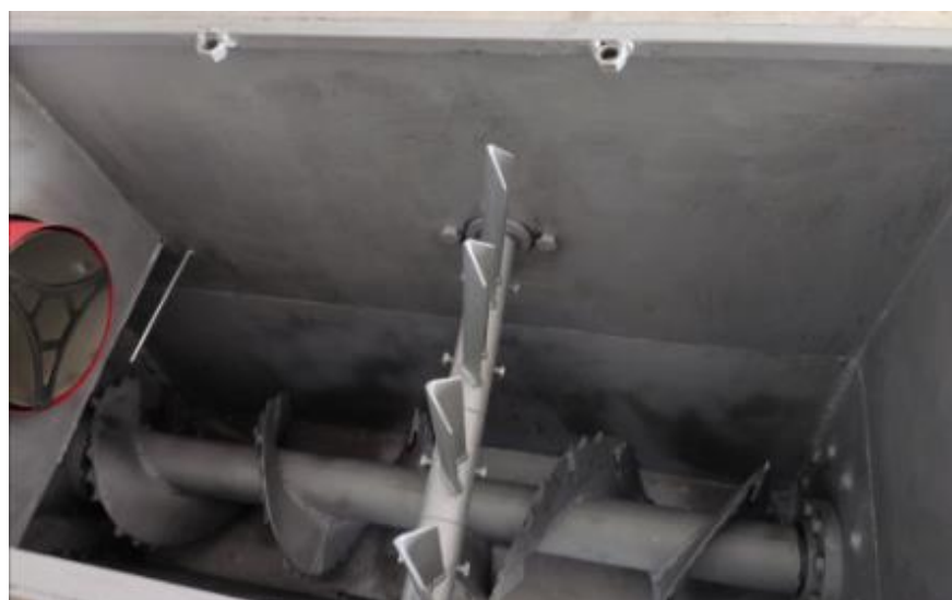
Рисунок 5 – Общий вид рабочей зоны с витково-ножевым шнеком и ударным устройством
