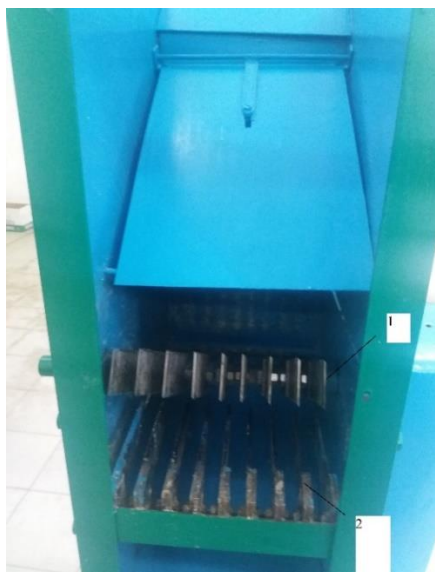
Рисунок 2 – Рабочие органы измельчителя корнеплодов: 1- ножи; 2 – противорезы.
