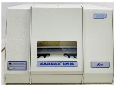
1-сурет – «Капель 105М» капиллярлық электрофорез жүйесі
